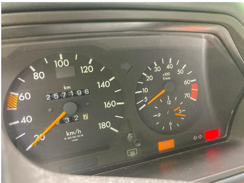
Um das System zu überwachen kann man eine (rote) Leuchtdiode mit 1k Ohm **Vorwiderstand** in eines der unbenutzten Kontrolllampen Öffnungen im Kombi Instrument von hinten einbauen / stecken und z. B. den „Pluspol“ der Diode mit den geschalteten Plus der ABS Kontrolllampe verbinden. Das andere Ende führt man mit einem Kabel links in den Motorraum und
