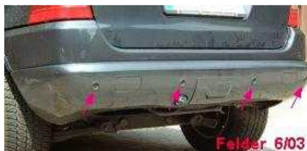
Abb. 28: Ultraschallsensor - Einparkhilfe
